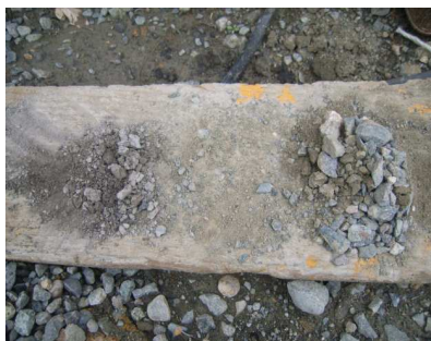
掘った土砂(大きい石も粉々に)
